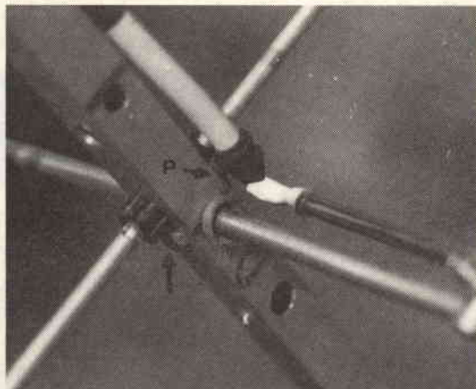
figura 2 - Esempio di connessione del cavo al dipolo senza connettore, già impermeabilizzato. La freccia indica la vite passante che attraversa il dipolo, bloccandolo, e fornisce all'esterno il «centro elettrico» del dipolo (punto P).
